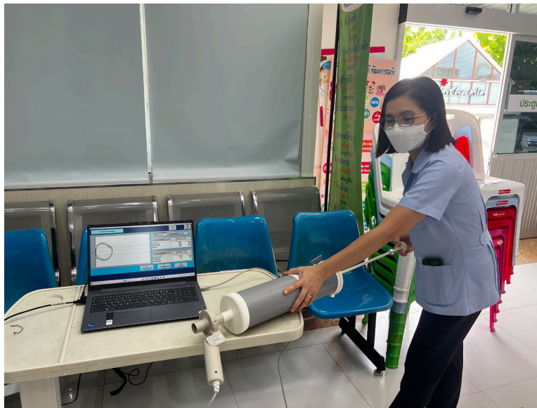
ก่อนการวัดสมรรถภาพปอด ต้องมีการทดสอบความเที่ยงของเครื่องมือทุกครั้ง
